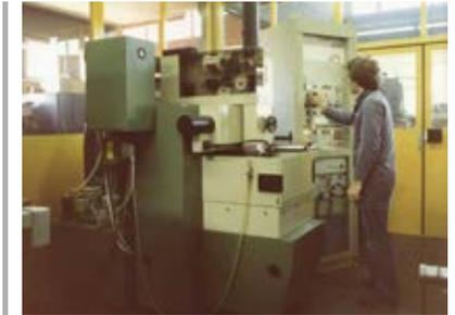
Die **Beschaffung der ersten Drahtrodiermaschine** ist ein grosser Schritt in der Werkzeugherstellung und ersetzt die bisher mühsamen, teils manuellen Bearbeitungsmethoden. Ein riesiger Schritt auch für die **reproduzierbare Qualität**.
